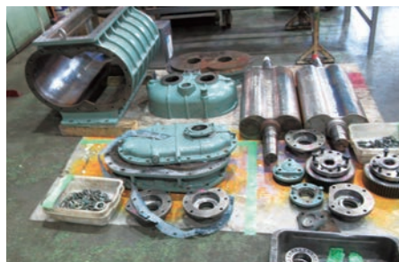
プロワ解体整備
